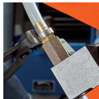
Uszczelnianie połączeń węży w układzie centralnego smarowania
