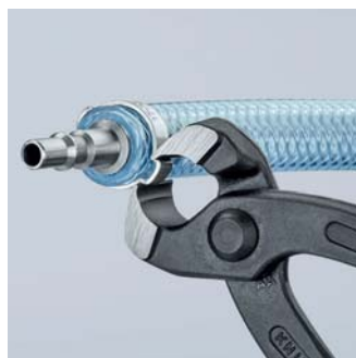
Uszczelnianie połączeń pneumatycznych w szybkozłączkach
