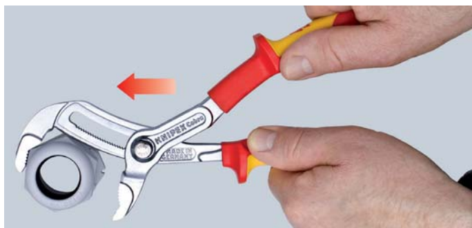
Szybka regulacja bezpośrednio na chwytanym przedmiocie bez naciskania przycisku
