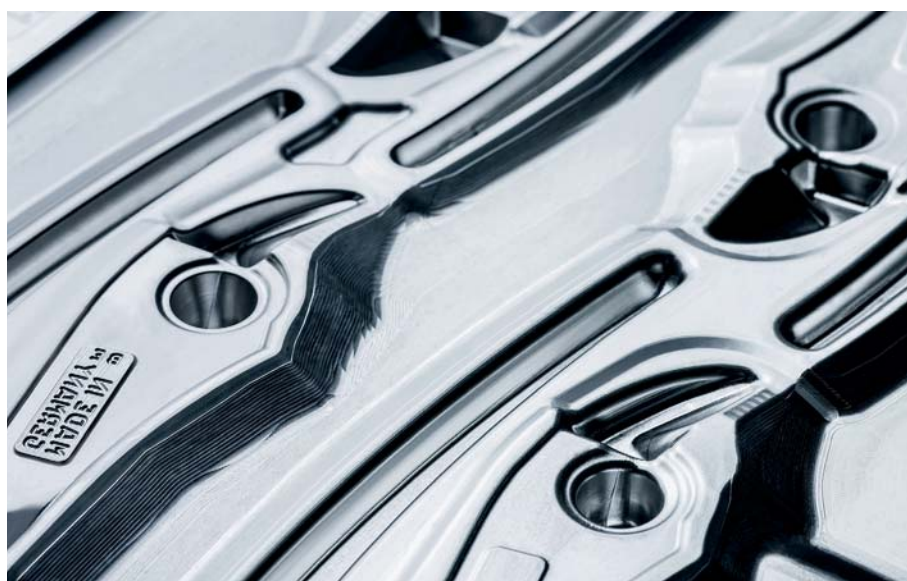
Matryca kuźnicza do szczypiec tnących bocznych o zwiększonym przełożeniu z kutym złączem czopowym.
