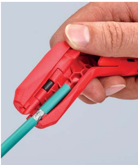
Usuwanie izolacji z przewodu teleinformatycznego
