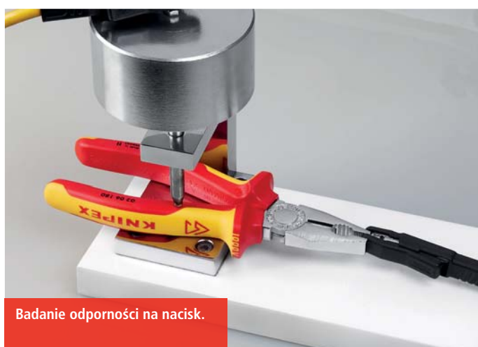
Badanie przyczepności powłoki izolacyjnej pod wpływem działania siły 500 N.
