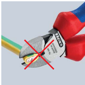
Cięcie za pomocą szczypiec bocznych: wymaga dużej siły, cięcie jest niedokładne, kabel zostaje w znacznym stopniu zdeformowany i zgnieciony
