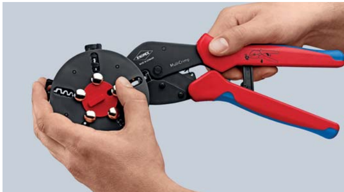
Wymiana matrycy do zagniatania: odblokować matrycę w magazynku, chwycić szczękami i wyjąć z magazynka
